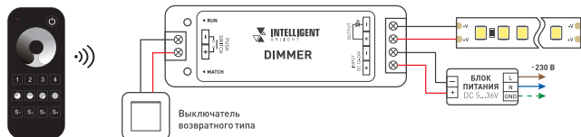
Рис. 1. Схема подключения диммера
